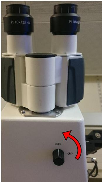
4- Baisser l'objectif à l'aide des mollettes sur le microscope. Puis dans le logiciel *MetaMorph* choisir l'objectif à utiliser. Ne pas changer l'objectif sur l'écran tactile ou sur les boutons du microscope.
